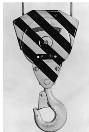
Bild 3: Gesicherte Einzugstelle an Seilrolle.
