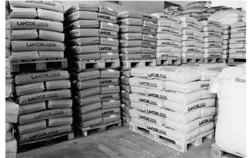
Figure 6: stockage de sacs avec planche intermédiaire. Pour conserver la qualité du produit, la hauteur d'empilage a été limitée à deux palettes.
