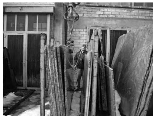
Figure 4: choix, élingage et transport en toute sécurité de dalles brutes. L'homme est en dehors de la zone dangereuse.
