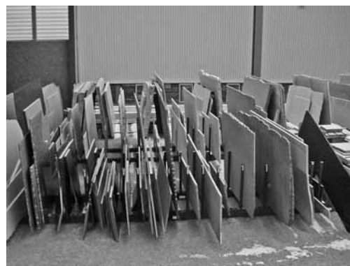
Figure 1: exemple de râtelier adapté pour les restes.
