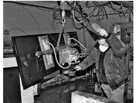
Figure 6: une formation est nécessaire pour utiliser en toute sécurité les palonniers à ventouses.
