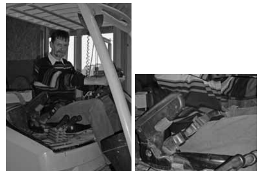
Figures 7 et 8: les caristes doivent être formés correctement et les chariots élévateurs doivent être équipés d'un système de retenue.
