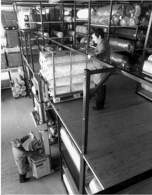
Bild 7: Bei niedrigem Lagergut (bis ca. 1 m Höhe) kann die Palette unter dem Geländer durchgeschoben werden. Die Geländerhöhe darf max. 1,2 m betragen. Das Geländer muss mindestens 0,5 m von der Sturzkante zurückversetzt sein, weil in diesem Bereich die Bord- und Zwischenleisten fehlen.
