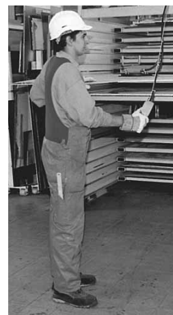
Figure 8: les équipements de protection individuelle (gants, chaussures, casque de protection) ainsi que l'utilisation d'accessoires adaptés réduisent les
