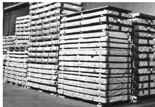
Figure 5: des carrelets de bois entre les paquets de tôles facilitent le désempilage avec un chariot élévateur.
