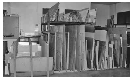
Figure 6: râtelier pour les tôles entières et les chutes.
