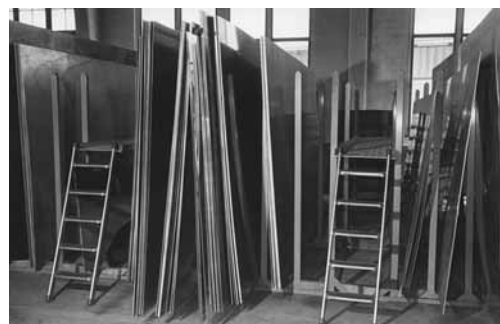
Figure 2: entreposage vertical de tôles dans des râteliers avec passerelle de service.
