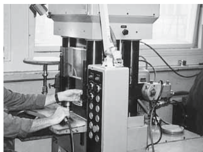
Fig. 4: dépose d'une pièce sur une presse équipée de l'appareil de protection des mains entraînant un écran.
