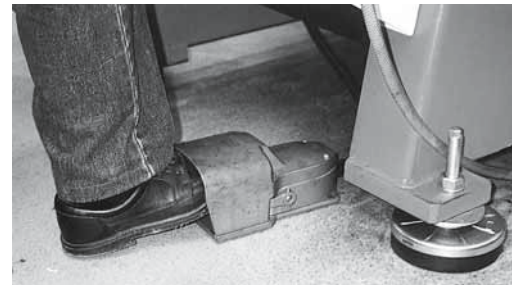
Fig. 2: la commande à pied (pédale) doit être équipée d'une cape de protection.
