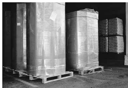
Figure 6: des matériaux correctement emballés et stockés peuvent être chargés sans problème.
